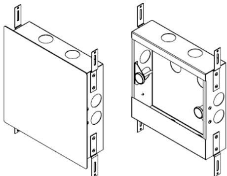
Golan outdoorbox bruges til skjulning af samling fra en udendørshane. Boxen indbygges i indervæggen og med tilslutning af et ø15mm RIR-rør. På bagsiden bores udendørshanen igennem og samles i skabet. Lugen er påsat med magneter og derfor nem adgang,
