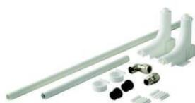
Radiator opføringssæt er et komplet opføringssæt til opføring af Ø15x2,5mm PEXrør i rør til forbindelse af radiator. Den medfølgende plastik bukkefix er 900 og sikre at tomrøret bukkes med rundt. Desuden medfølger en rørtætning, der tætner imellem PEXrøret og tomrøret, så en mulig lækage på PEXrøret vil sikre at vandet løber tilbage til fordelene og ikke laver vandskade under et evt. gulv.
