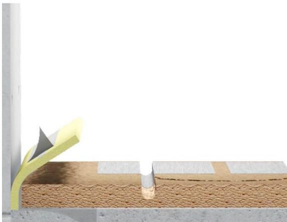
Isoleringen fastgøres til vægge ved at fjerne beskyttelseslaget på tapen og trykke den ind på væggen.
